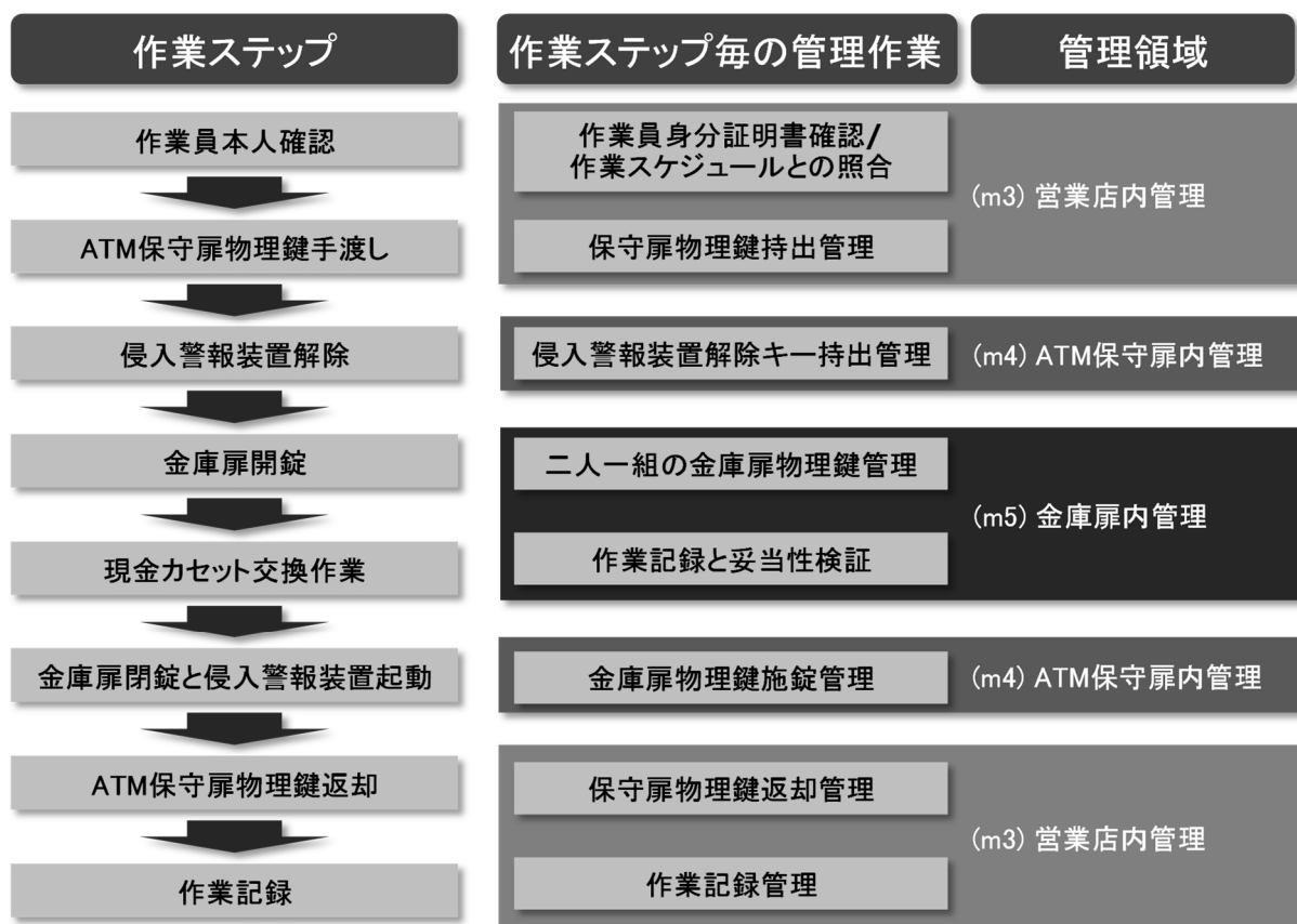
図 2-4 警送作業の作業ステップへの分解と管理領域の分類例
